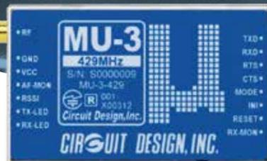
ワンチップCPUのUARTやパソコンのCOMポート(RS232C)とインターフェース可能なコマンドコントロールの無線モデムです。
