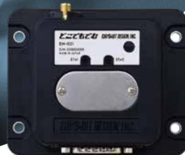
どこでも、機器やセンサーをつなぐだけで、無線データ伝送できるプログラム可能な無線ユニットで、IoT通信ソリューション構築に適した無線機器です。
